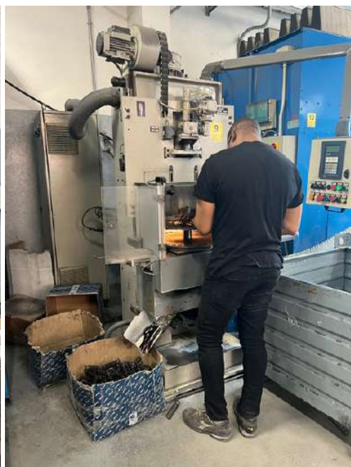
Macchina molatrice in lavorazione
