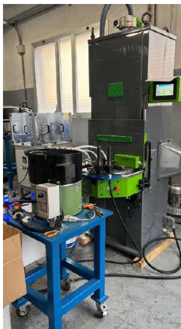
Macchina molatrice con in linea banco di assestamento automatico
